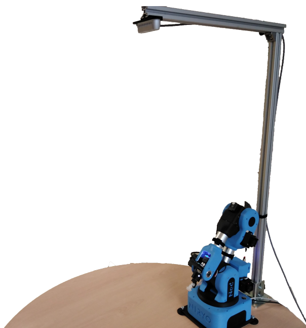
6.15 Irudia: Kamera eta bere euskarria eszena fisikoan.
