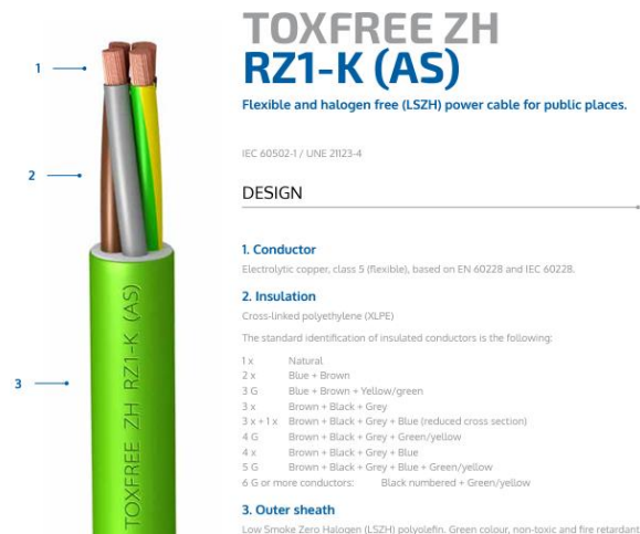
Imagen 47. Cable utilizado en AC [Anexo III, 8]
