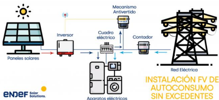
Imagen 21. Esquema de instalación sin excedentes [19]
