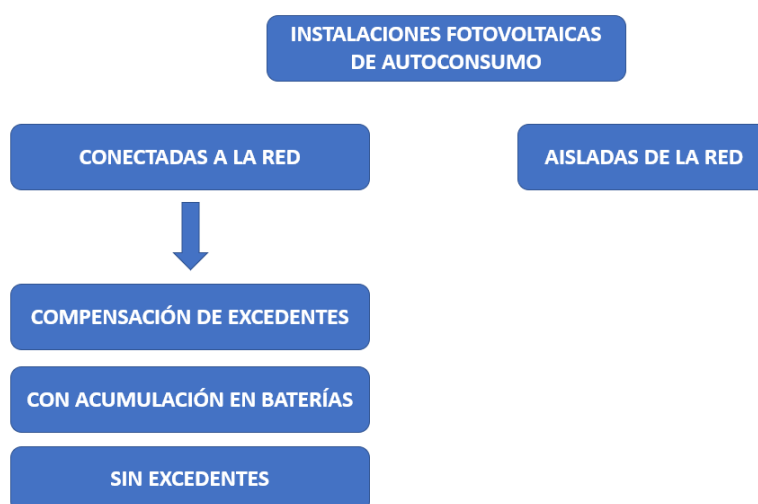
Imagen 18. Tipos de instalaciones fotovoltaicas
