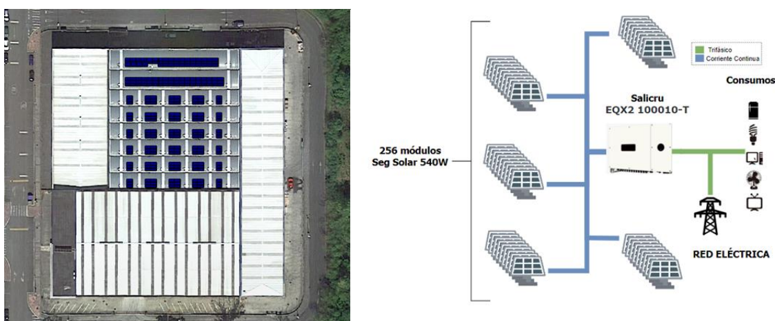
Imagen 25. Instalación de 138 kWp
