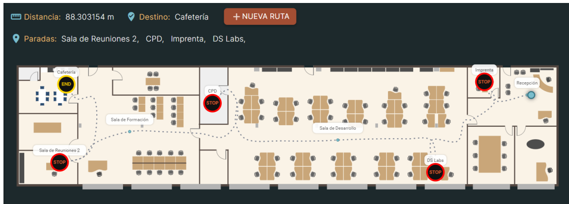
Figura 5.6 – Ruta obtenida con el algoritmo de Dijkstra con cuatro puntos intermedios.
