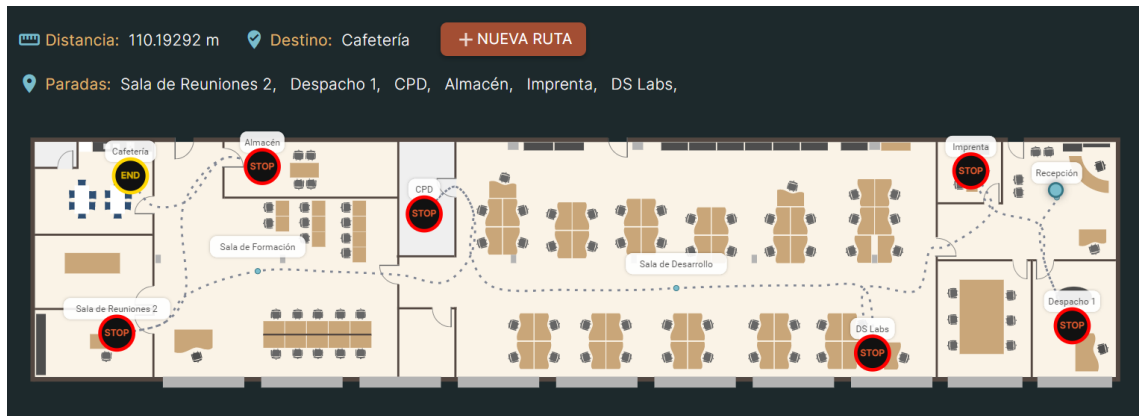
Figura 5.8 – Ruta obtenida con el algoritmo de Dijkstra con seis puntos intermedios.
