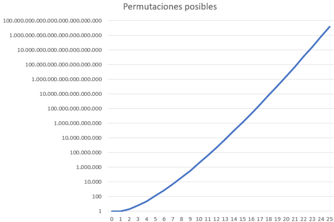
Figura 8.4 – Gráfica de crecimiento de las posibles soluciones según el número de puntos intermedios.
