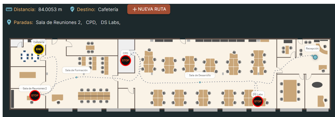
Figura 5.5 – Ruta obtenida con el algoritmo de Dijkstra con tres puntos intermedios.
