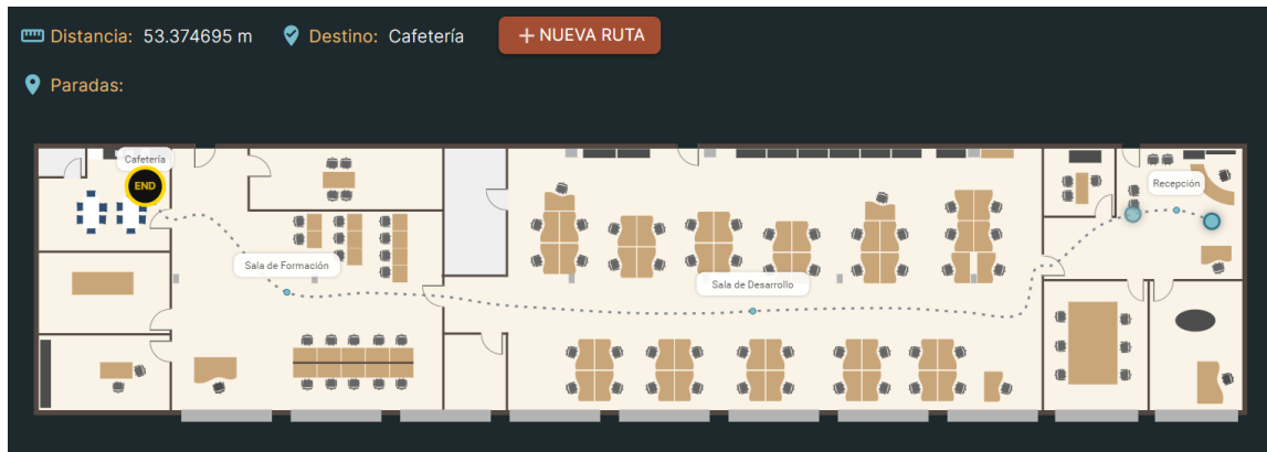
Figura 5.2 – Ruta obtenida con el algoritmo de Dijkstra sin puntos intermedios.
