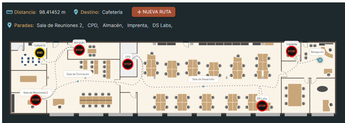
Figura 5.7 – Ruta obtenida con el algoritmo de Dijkstra con cinco puntos intermedios.
