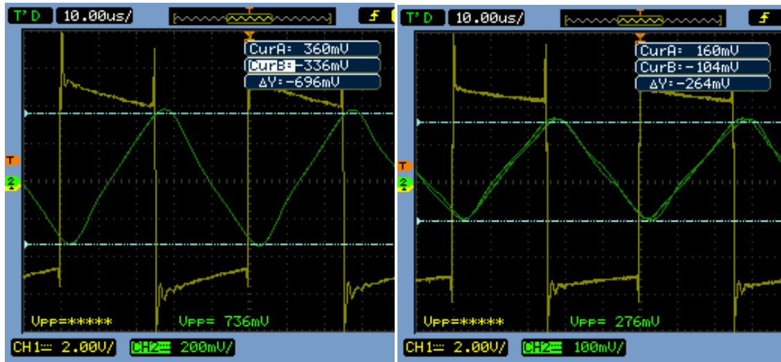
26. Irudia – Bihurgailuarekin lortutako neurketen seinaleak a) Sekundarioa z. irekian b) Primarioa z. irekian
