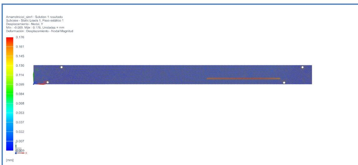
**Ilustración 98** - Análisis final. Desplazamiento nodal en y
