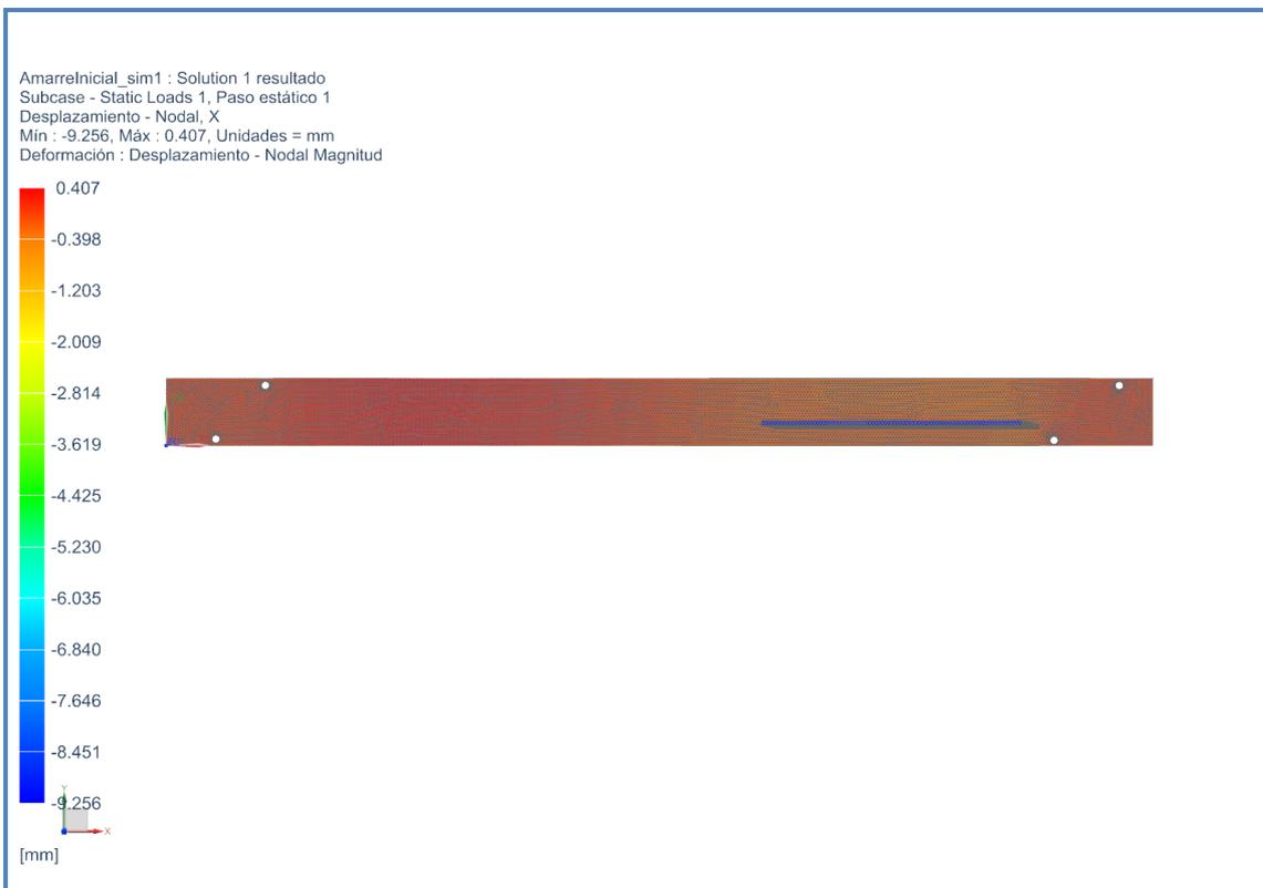
**Ilustración 88** - Análisis solución I. Desplazamiento nodal en x
