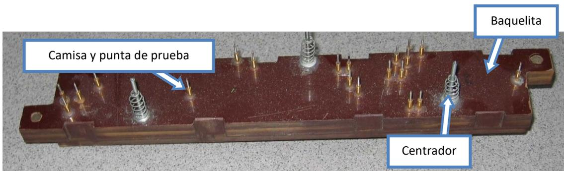
**Ilustración 28** - Baquelita con los demás elementos integrados en el lecho
