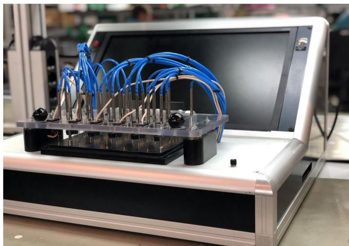
**Ilustración 14** - Cama de pinchos de test funcional mediante neumática de la empresa Selectica.
