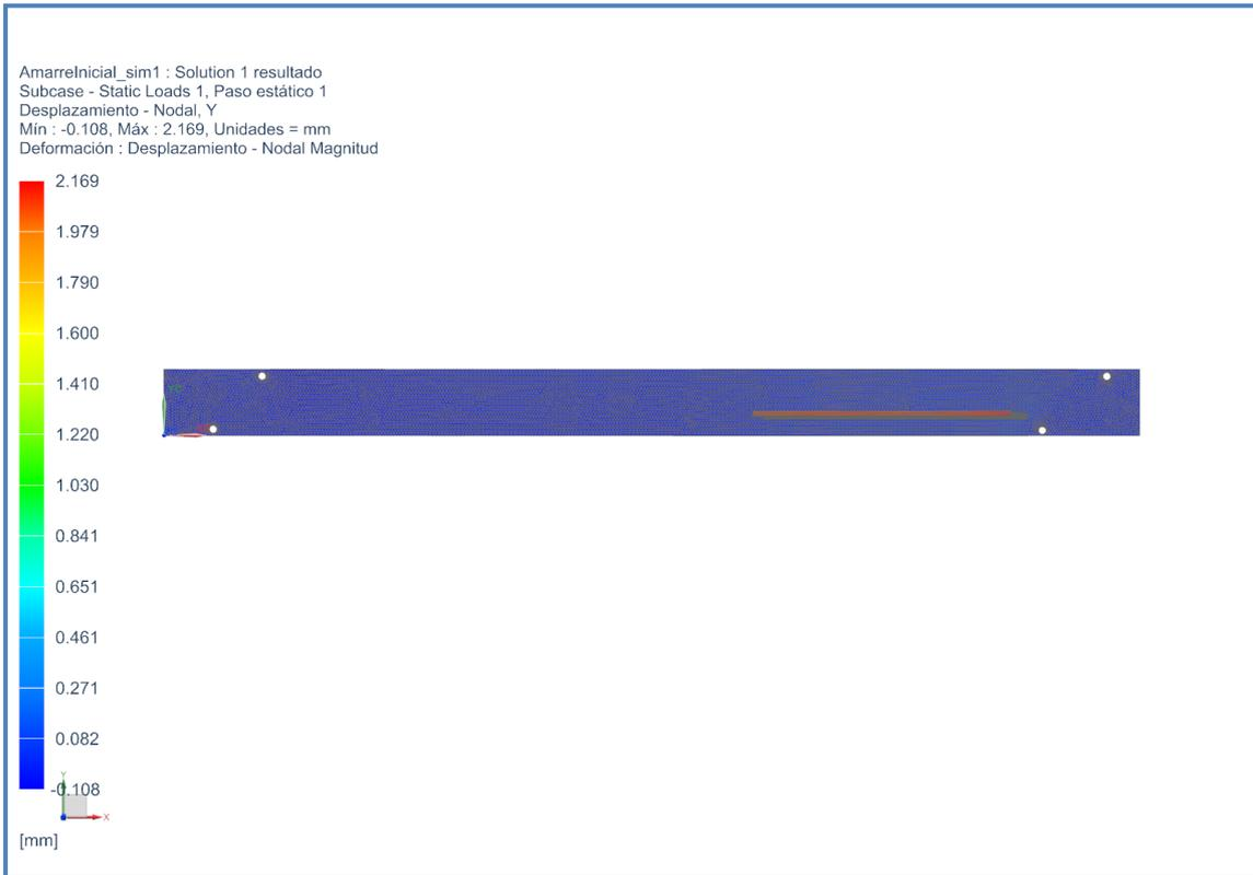
**Ilustración 89** - Análisis solución I. Desplazamiento nodal en y
