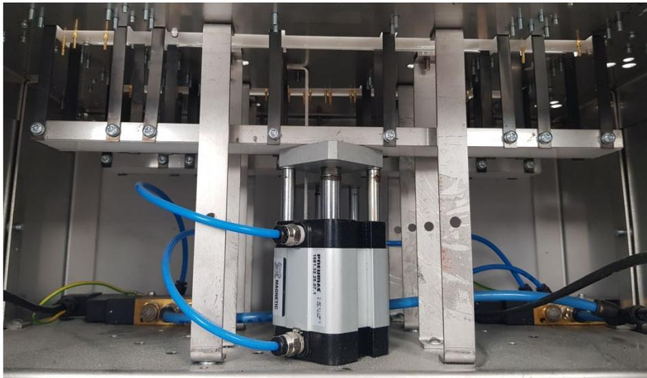
Ilustración 155 - Plataforma unida al cilindro y las uñas de amarre
