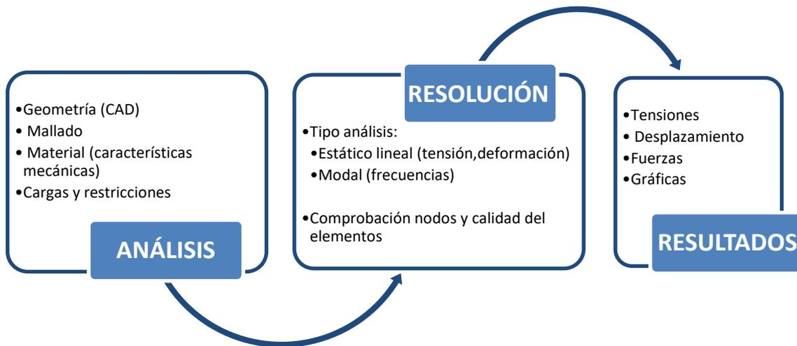
**Ilustración 186** - Fases simulación FEM
