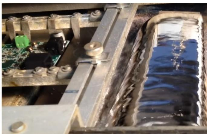
Ilustración 62 - Soldadura por ola
