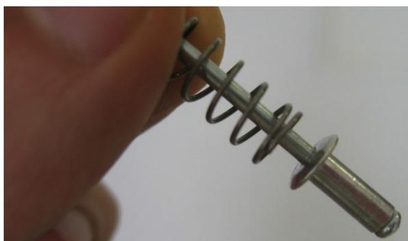
*Ilustración 126 - Detalle de muelle y centrador*
