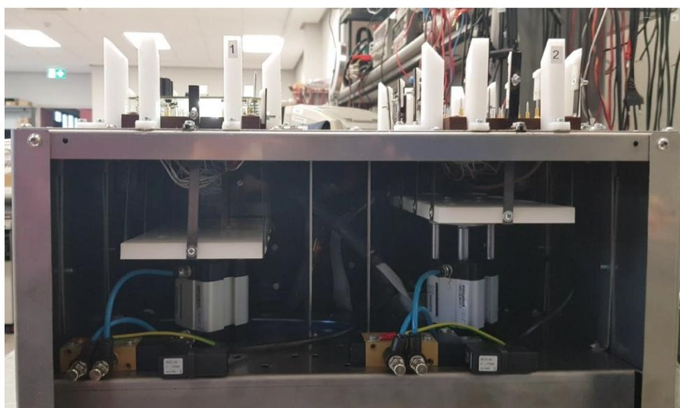
**Ilustración 183** - Detalle de la carrera de avance y retroceso del cilindro neumático en cama NLED-201
