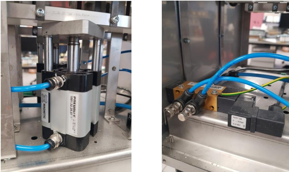
[Ilustración 39](#) - Sistema neumático, formado por electroválvulas y cilindro neumático
