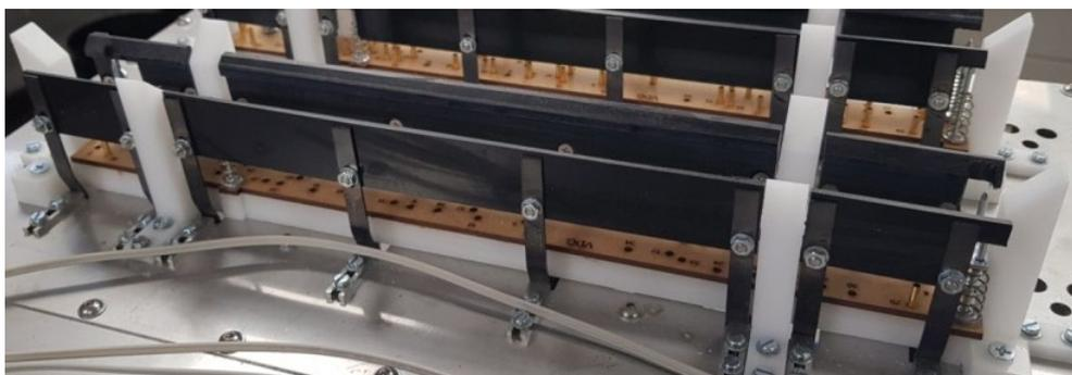
*Ilustración 74 - Detalle de la unión la pared con las chapas*
