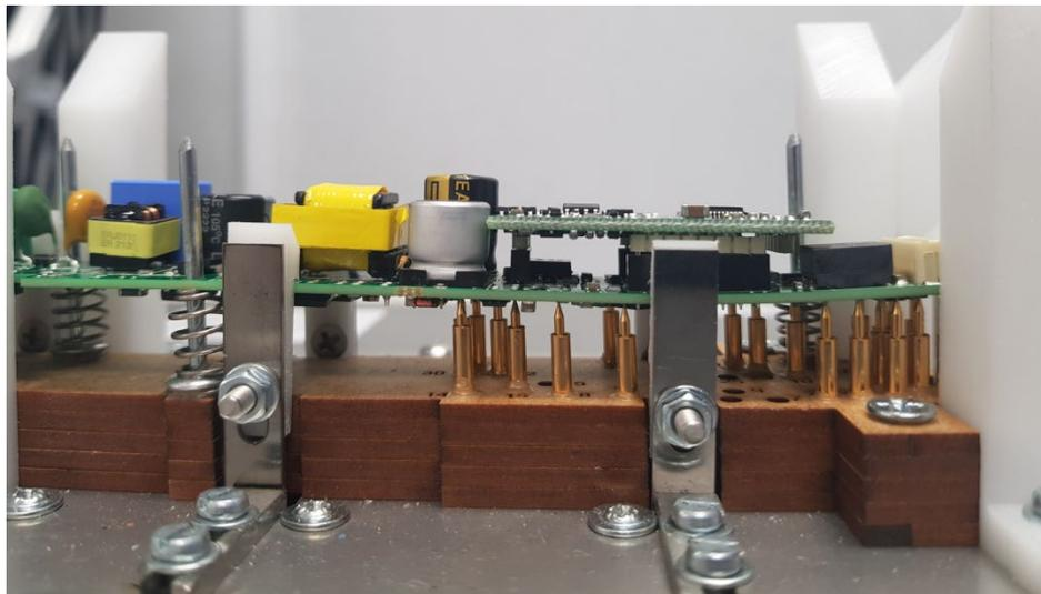
***Ilustración 66** - Deformaciones de una placa amarrada durante sus pruebas*
