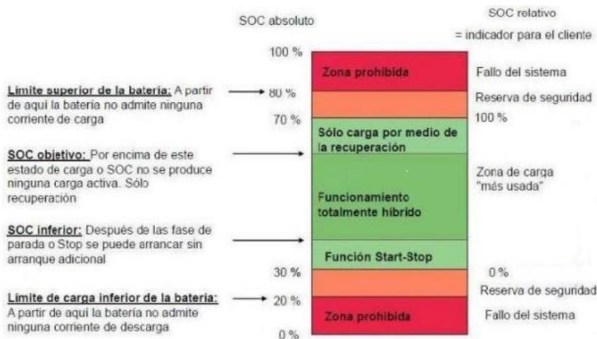
Ilustración 25. SoC de una batería
