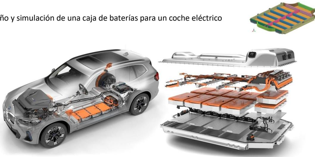
*Ilustración 6. Despiece caja de baterías de vehículo eléctrico*
