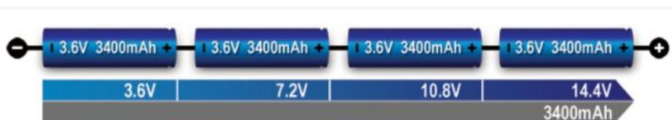
Ilustración 19. Baterías conectadas en serie
