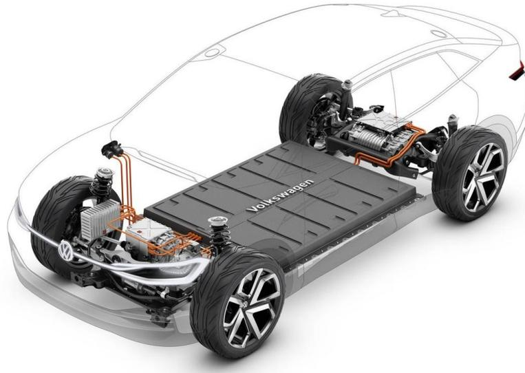
*Ilustración 7. Caja de batería de distribución en suelo*
