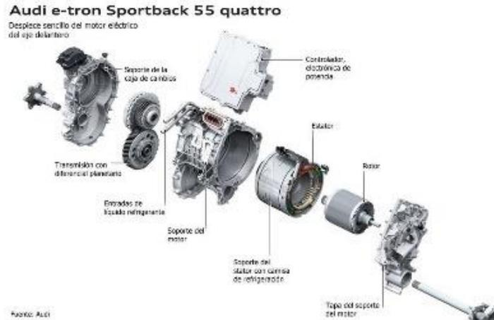
Ilustración 40. Motor eléctrico
