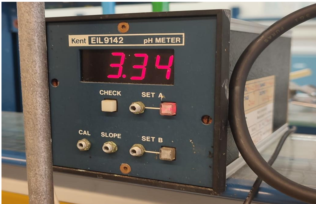
Figura 4.3. Controlador de pH (Kent EIL 9142).
