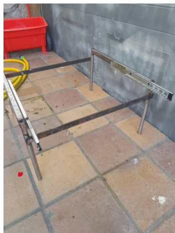
Ilustración 10 Estructura central con las vías de desplazamiento horizontal
