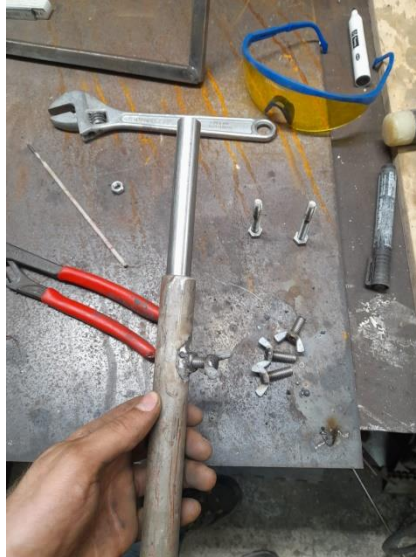
Ilustración 9 Palomilla que enlaza la estructura inferior y central dando un juego de altura
