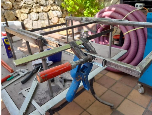
Ilustración 11 Vías horizontales en la estructura superior
