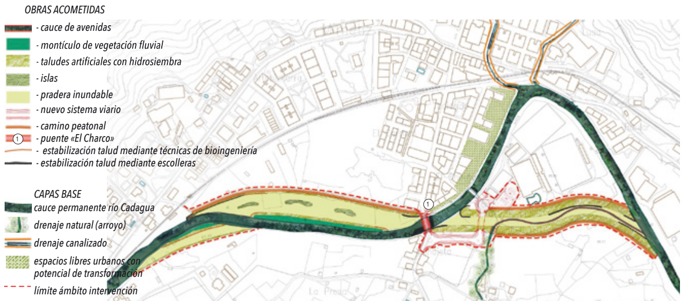
Figura 224. Planta de la intervención. Fuente: elaboración propia en base a la documentación del proyecto de URA, FULCRUM (2019)
