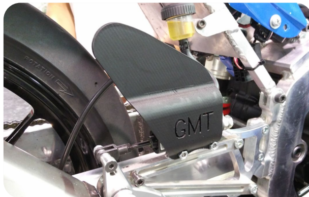
Figura 6. Montaje de uno de los protectores definitivos.
