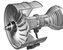
Corte transversal de una turbina de motor de aviación. Figura 1.3 Ashby vol 1. 978-84-291-7255-3 © Ed. Reverte, 2008
