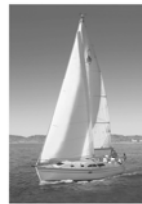
Un velero de recreo, con casco de material compuesto (CFRP), mástil de aleación de aluminio y velas de fibra sintética de polímero. Figura 1.5 Ashby vol 1. 978-84-291-7255-3 © Ed. Reverte, 2008
