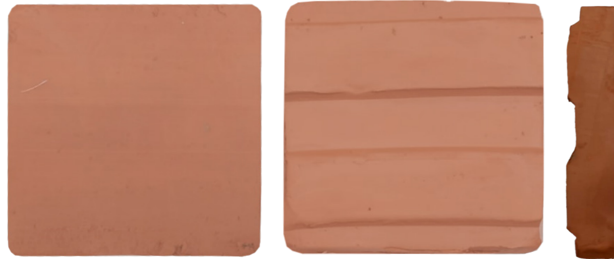
Figura 180. Aspecto de la pieza bizcochada fabricada en masa tras su cocción.
