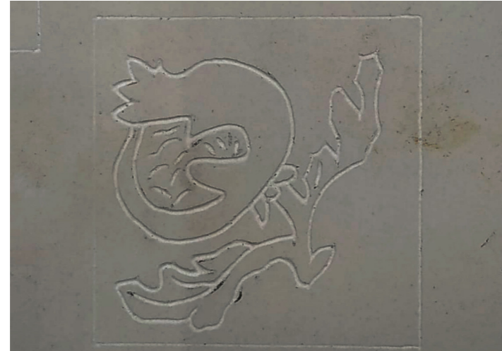
Figura 184. Grabar el patrón sobre una tabla lisa de escayola.
