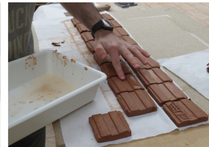
Figura 196. Repasar imperfecciones para suavizar la superficie y acabado de las piezas.
