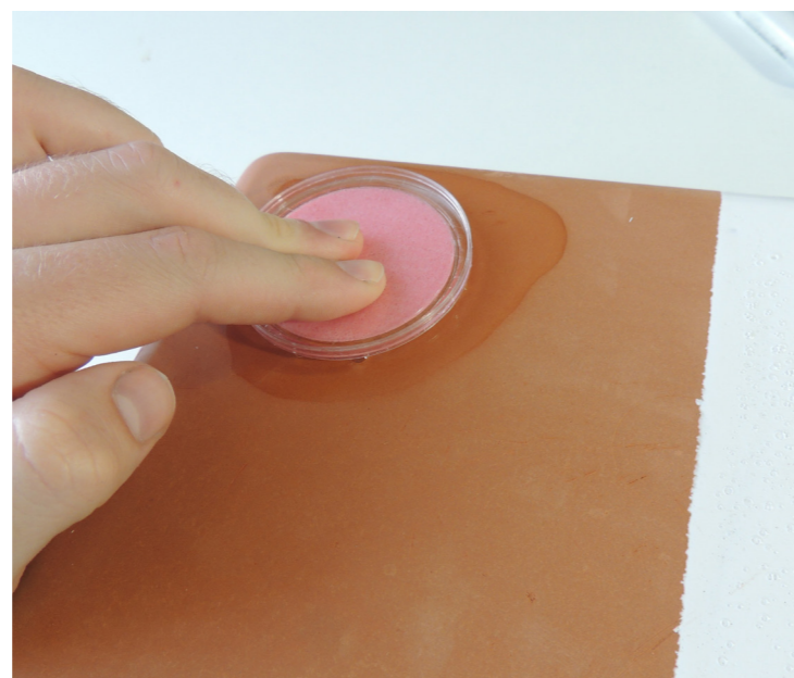
Figura 13. Prueba de porosidad y absorción de agua de un material cerámico.
