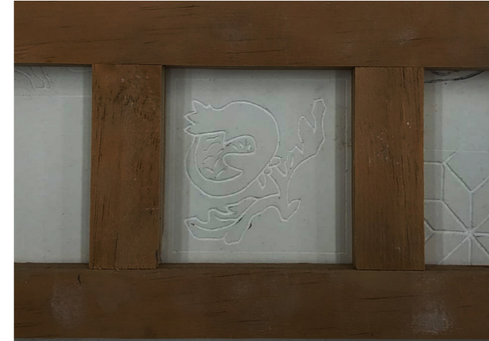
Figura 185. Crear un marco de madera un 8% mayor y más alto que las medidas finales deseadas.
