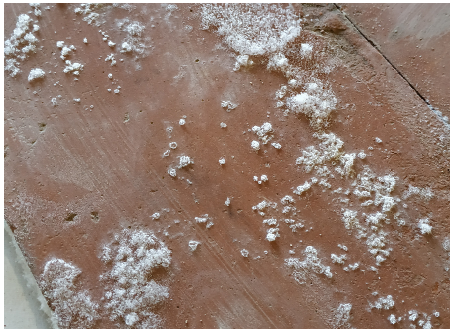
Figura 56. Presencia de cristales de sales solubles sobre la superficie de una baldosa cerámica bizcochada.
