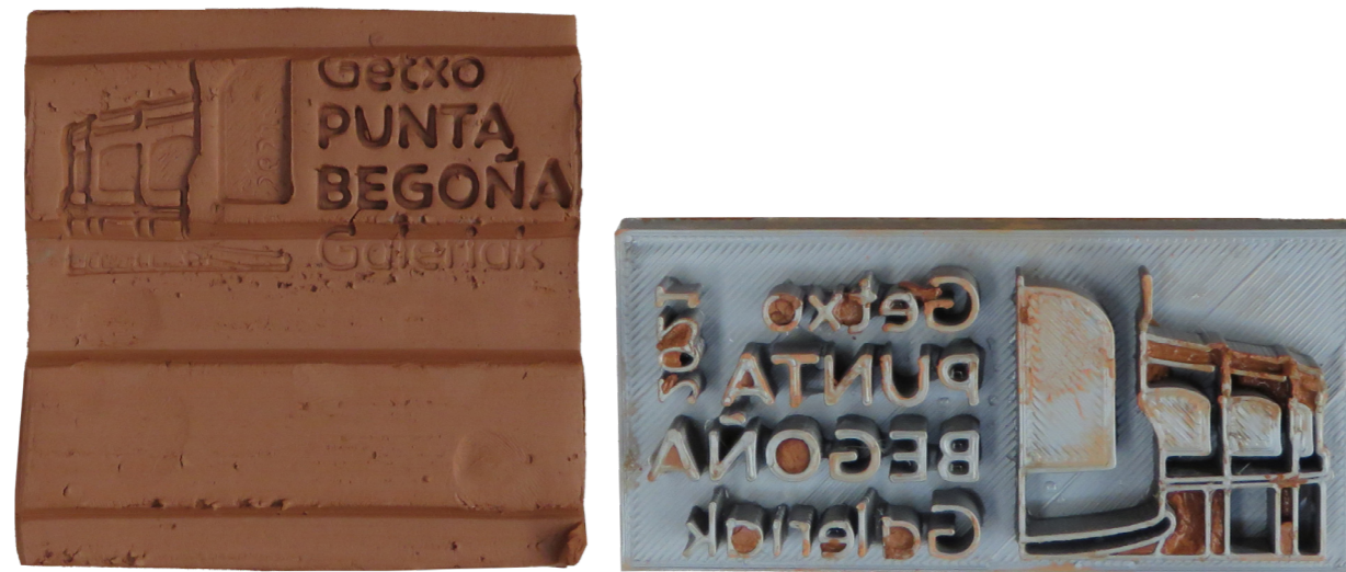
Figura 181. Estampación del sello 3D en el reverso de la olabrilla a modo de registro.
