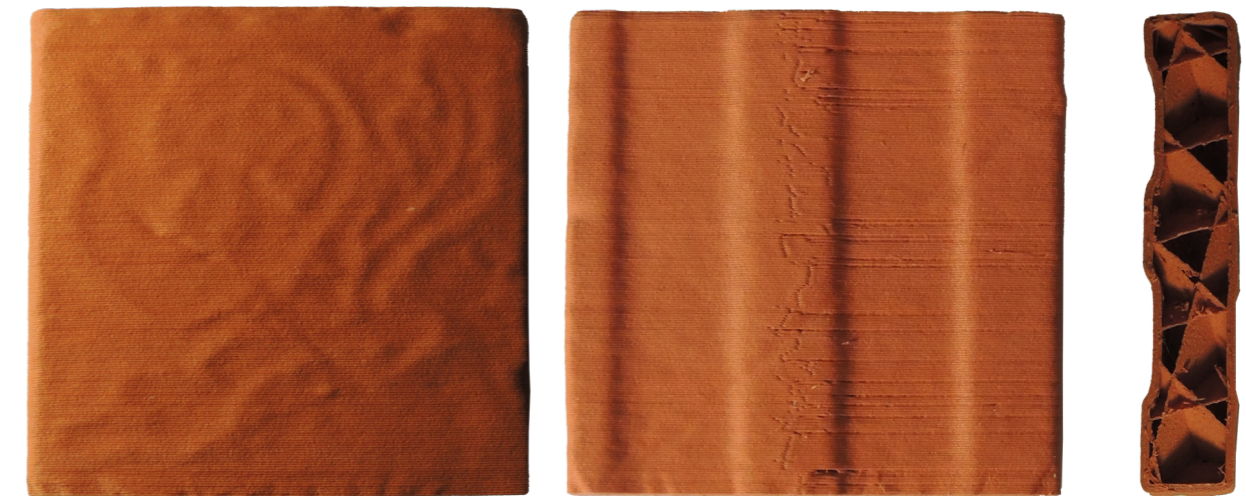
Figura 182. Pieza creada a partir de fotogrametría e impresa con filamento de PLA y partículas de cerámica.
