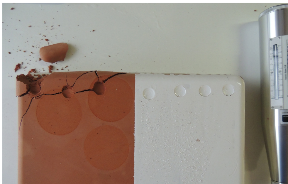
Figura 150 (arriba, izq.). Medición de dureza con el martillo de Smith.
