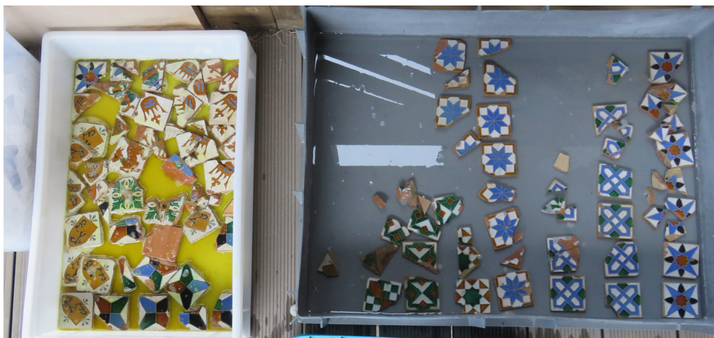
Figura 89. Baños de ácido y posterior desacidificación.
