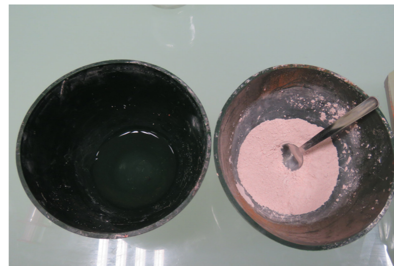
Figura 107. Elaboración de la mezcla de escayola con chamota y vertido.
