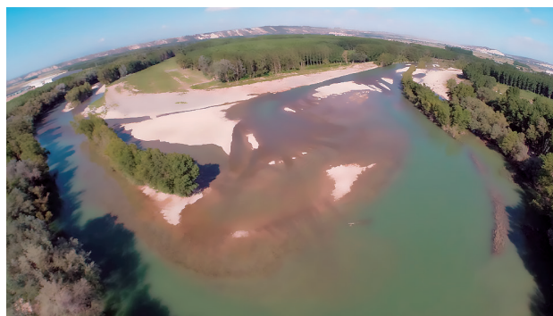
Fig. 5 – Tronçon restauré avec un apport de sédiments dans le fleuve Aragon (Sotocontindas, Marcilla)
