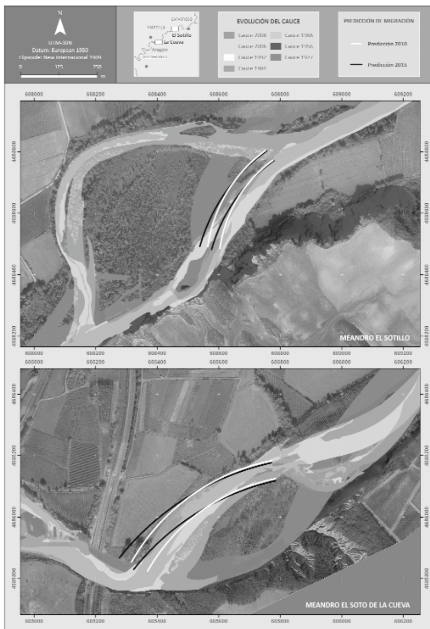
Figura 8. Dinámica de los meandros de El Sotillo y Soto de la Cueva y predicción de su migración.
