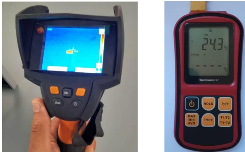
Figura 4.5 Cámara termográfica testo 875i y termómetro con sonda de superficie.
