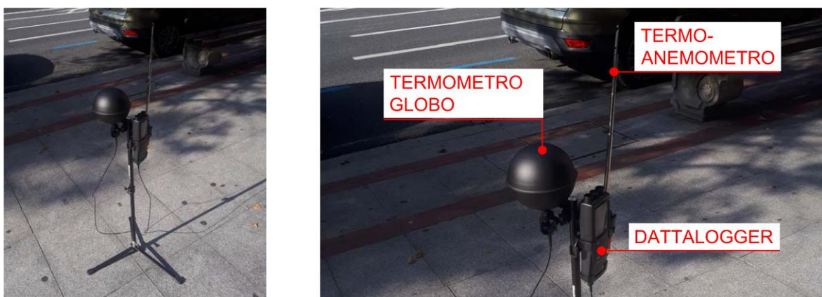
Figura 4.4 Instrumentos para la campaña de medición de Tmrt.
