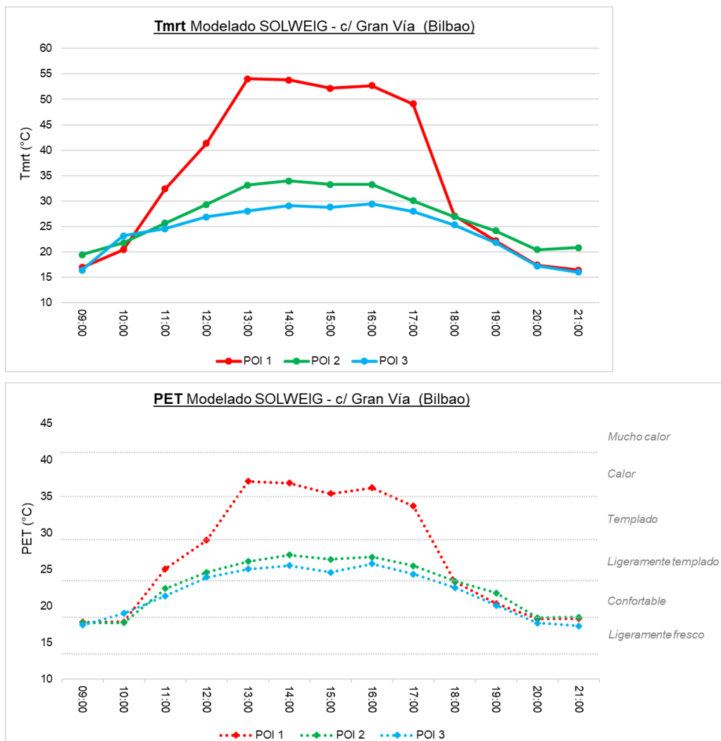
Figura 6.7 Valores Tmrt y PET de los tres puntos (POI) considerados en la c/ Gran Vía según modelado SOLWEIG con datos meteorológicos del 30 de agosto de 2019. Niveles de percepción térmica del índice PET para Europa Central.
