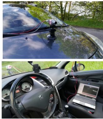
Figura 21: Montaje de la cámara en la parte frontal del vehículo (superior) y ordenador portátil grabando en el asiento del copiloto (inferior)[1].
