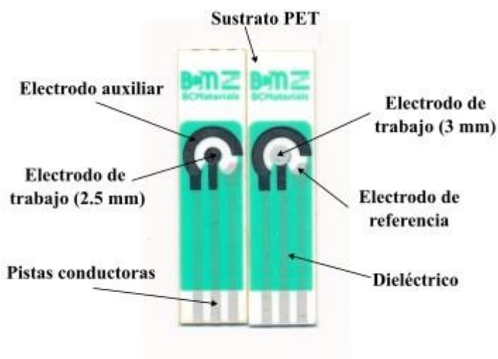
Figura 6. Partes de un electrodo de grafito (izquierda) y con la tinta WO 3 -ATO (derecha).
