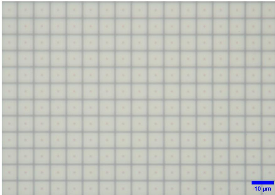
Figura 8: Imagen de los microespejos del DMD 6500 obtenida con un objetivo de 100 aumentos en el microscopio
