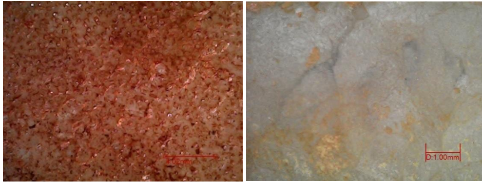
Figura 12.- Superficie de las probetas sometidas a (izquierda) Mezcla y (dcha) Lluvia ácida.
