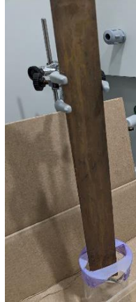
Figura 7.- Aspecto de la lámina de hierro tras su oxidación con la disolución de lluvia ácida.
