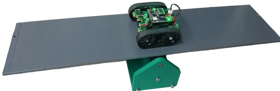
Figura 3.20: Sistema robot balancín.
