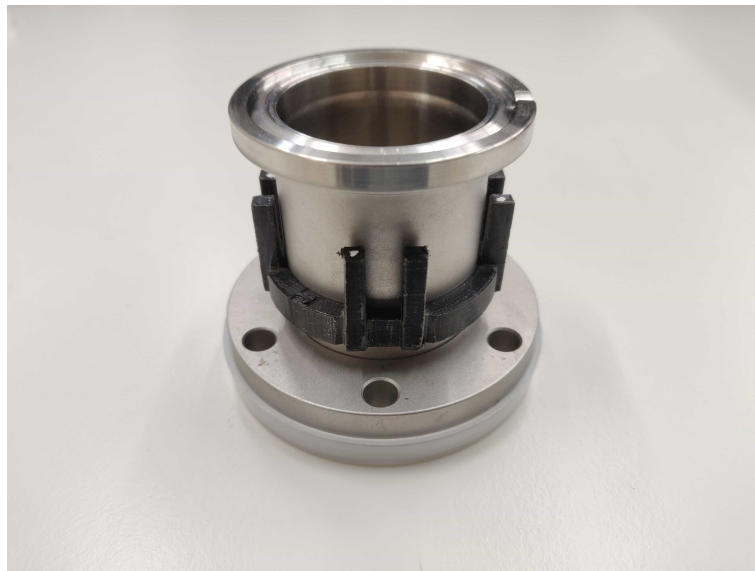
Figura 4.2.24: Estructura diseñada acoplada en una muestra del tubo del haz.
