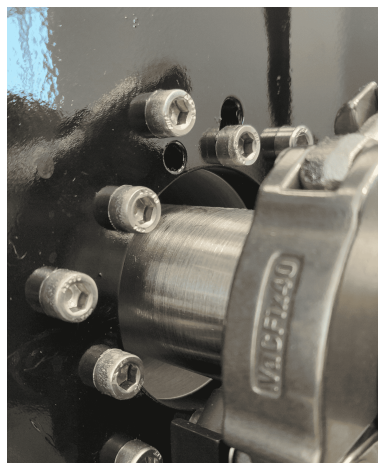
Figura 3.1.13: Restricción de tamaño del sensor. El espacio entre el tubo del haz y la carcasa de acero (negro) es de 10 mm.
