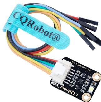
Figura 13: Sensor de color TCS34725 de CQRobot
