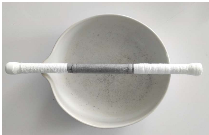
Figura 15.- Soporte con la primera capa de zeolita cristalizada por síntesis hidrotérmica (Mordenita).
