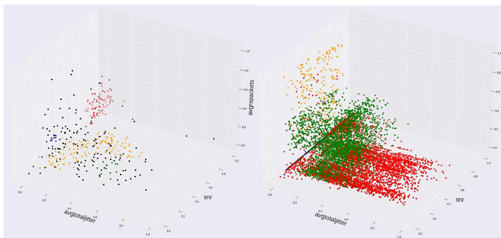
Figura 43: Resultados de agrupación DBSCAN sobre las métricas preprocesadas de APs (izq.) y STAs (der.).
