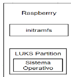
Figura 15: Raspberry. Configuración de las diferentes partes participantes
