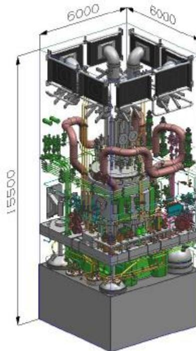
Figura 3.23: Disposición de los sistemas integrados en la contención del RITM-200.
