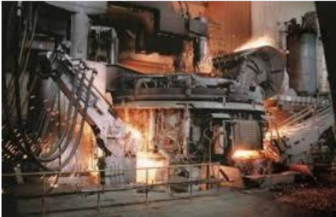
Figura 7. Horno de arco eléctrico de corriente directa (DC) [5].
