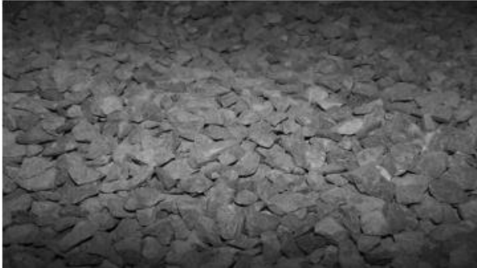
Figura 17. Cal dolomítica dentro de su respectivo silo [5].
