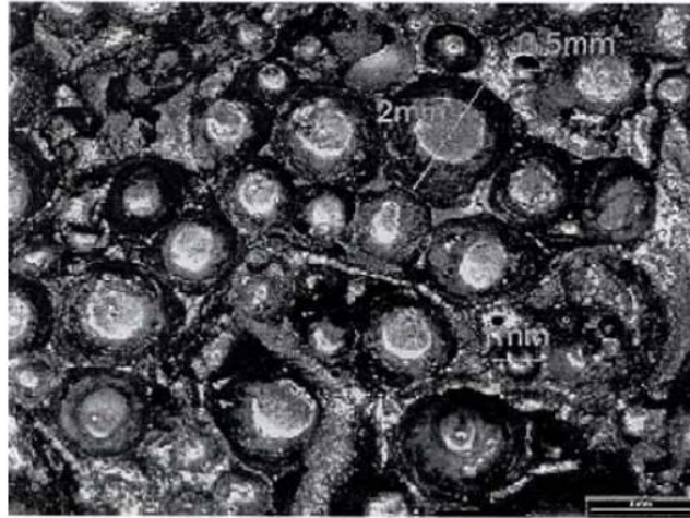
Figura 21. Burbujas esféricas observadas en una escoria bien espumada [11].
