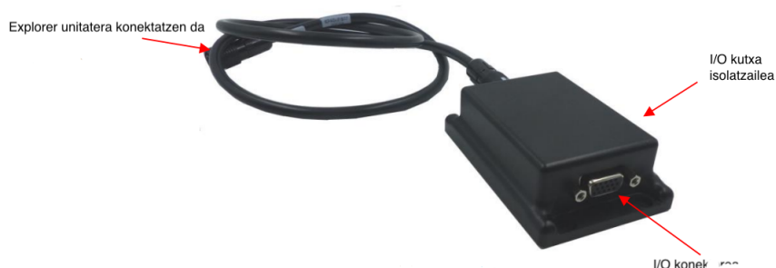
Irudia 14: Explorer 64/128 gailura konektatzen den kutxa isolatzailea. Input eta Output-ak bertara konektatzen dira Explorer-a babesteko [15].
