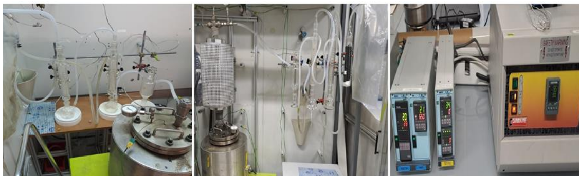
Figura 11. Fotografías de la instalación de pirólisis y controladores de temperaturas.
