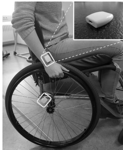
Figura 3. Dispositivo Activ8 basado en acelerómetros triaxiales [6]
