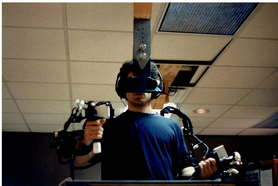
Figura 3.10: Primer sistema real de RA, Virtual Fixtures , creado por el tecnólogo Louis Rosenberg 8
