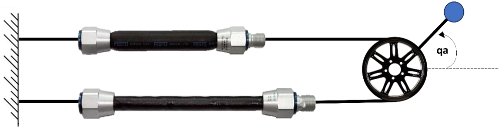
Figura 35: Configuración antagonista de 2 músculos neumáticos
