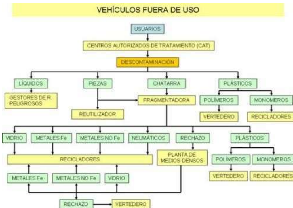
Figura 19. Esquema de tratamiento de VFVU (MITECO, s.f.).
