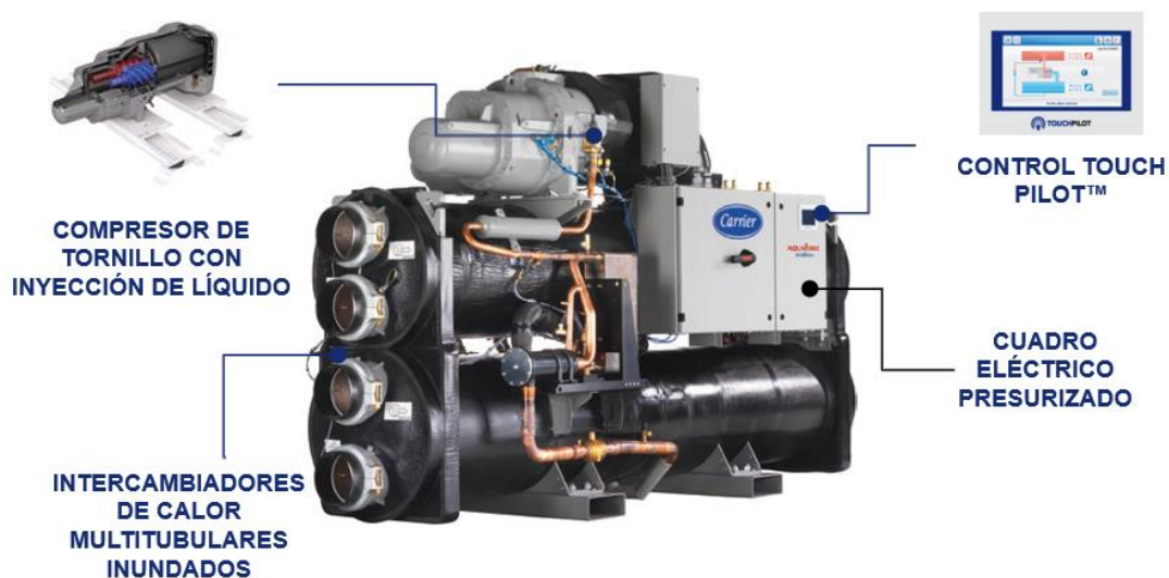
Imagen 7: Bomba de Calor de Alta Temperatura modelo 61XWH (Fuente: Presentación Carrier por Joaquín Fernández)
