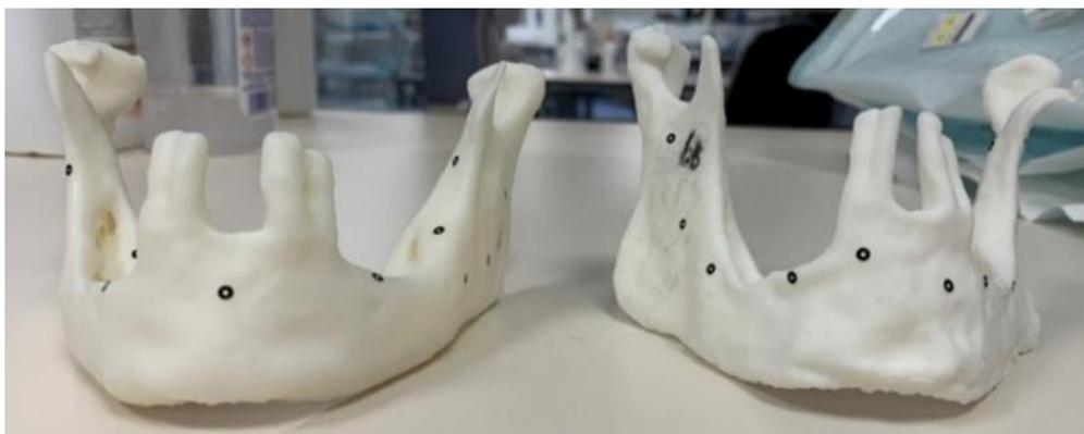
Figura 5.29. Comparación entre la mandíbula 6A (derecha) y la 6B (izquierda). Evidencia de deterioro físico en la mandíbula 6A, fabricada en PLA y sometida al proceso de esterilización en autoclave.
