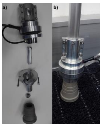
Figura 1. (a) Despiece de las partes mecanizadas. (b) Ensamblaje montado en la muleta. (13)
