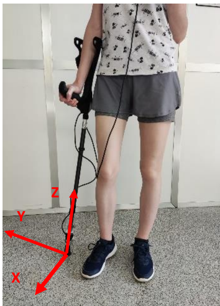
Figura 2. Participante portando la muleta y los ejes correspondientes al movimiento de la misma.
