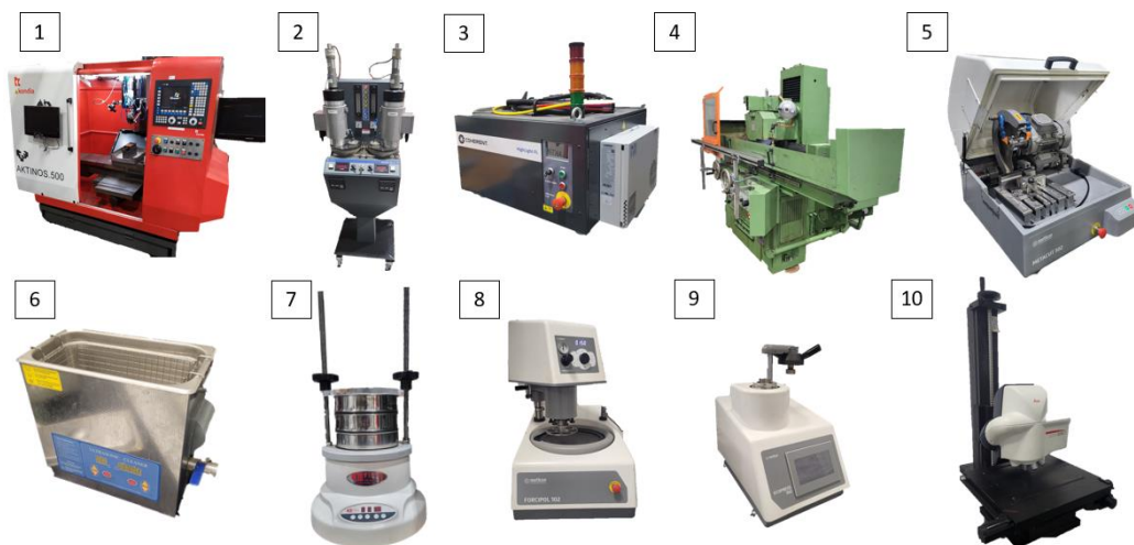
Figura 10: Equipos utilizados: 1.-Centro DED 2.-Alimentador de polvo 3.-Fuente del láser 4.-Rectificadora 5.-Sierra metalográfica 6.-Limpiadora de ultrasonidos 7.-Torre de tamicas 8.-Pulidora 9.-Encapsuladora 10.-Microscopio Leica
