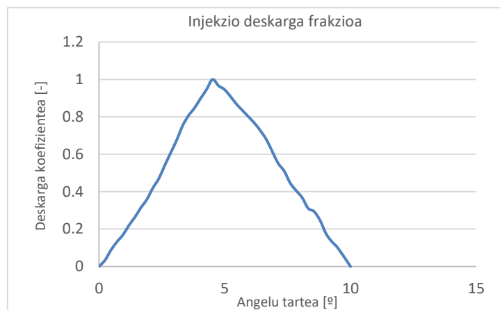
Irudia 42. Injekzio deskarga frakzia cranc angeluaren menpe
