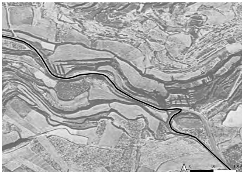
Ilustración 59: Curva en zigzag para salvar el desnivel entre el fondo del barranco del río Macarralde y la planicie donde se ubica Labastida.
