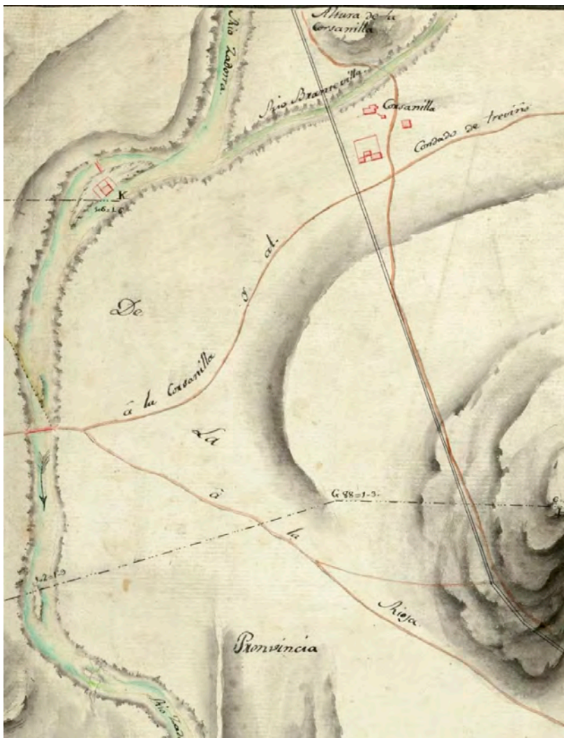
Ilustración 41: Plano del paraje de Lacornzanilla donde podemos ver el camino antiguo de las Conchas y el diseñado por Olaguíbel, mucho más recto. Fuente: A.C.E.G.C.G.E, Ar.F- T.1-C.2_74 (ca. 1800).
