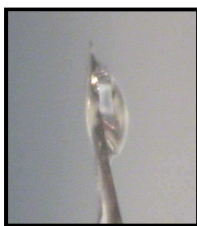
Fig.3.6. Imagen ampliada del monocristal del complejo de inclusión acetamiprid:CD, montado en la "plumilla".
