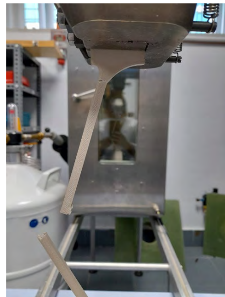
Figura 69: Ensayo de tracción pieza acodada octogonal al 50%
