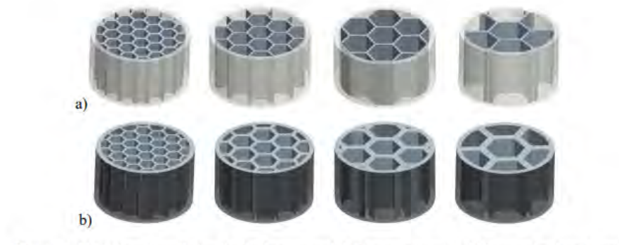
Figura 17: Variaciones en el tamaño de celda. (a) modificación de porosidad a espesor constante, (b) modificación espesor a porosidad constante. Fuente: Materials&Design 2018
