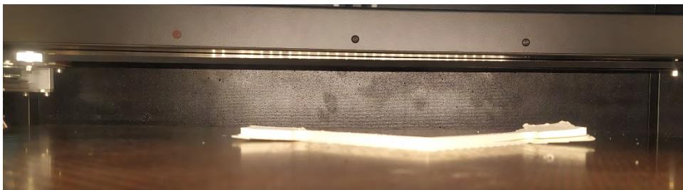
Figura 65: Alabeo de pieza octogonal
