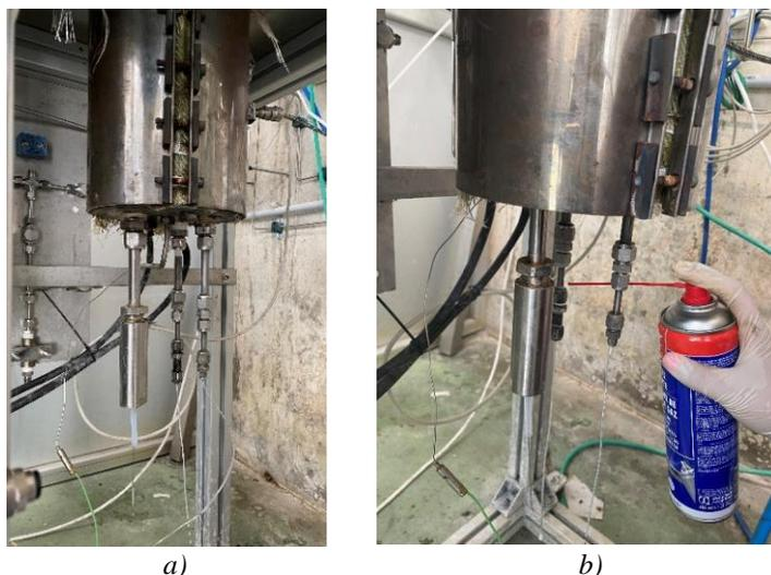
*Figura 3.27. a) Colocación de los electrodos necesarios durante el ensayo electroquímico (electrodo de referencia, electrodo de trabajo y contraelectrodo). b) Proceso de detección de fugas mediante el detector de fugas de gas.*
