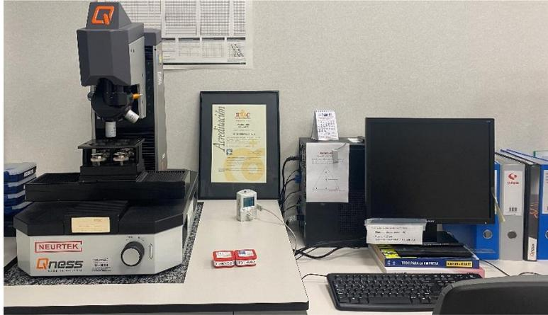
*Figura 3.19. Durómetro Vickers QNESS 10 A+ del laboratorio de Tubacex Innovación (Derio, Bizkaia).*
