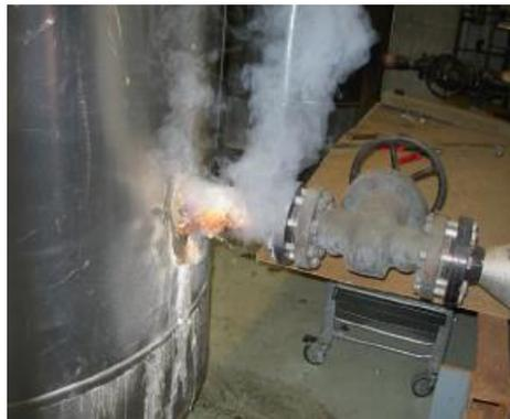
*Figura 2.7. Tubería de vapor geotérmico en Islandia que presenta fragilización por hidrógeno (HE).*
