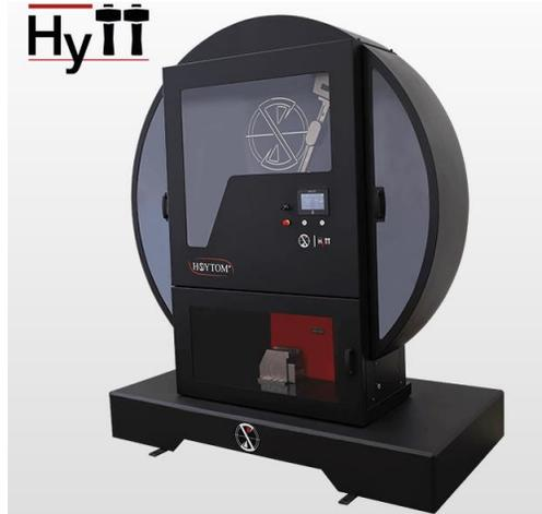
*Figura 3.21. Péndulo Charpy Hoytom utilizado para la medida de la tenacidad del acero inoxidable dúplex o superdúplex.*
