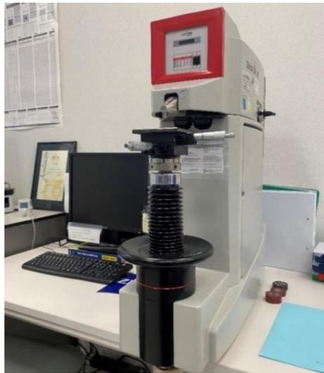
*Figura 3.20. Durómetro Rockwell Zwick Roell 4150BK del laboratorio de Tubacex Innovación (Derio, Bizkaia).*
