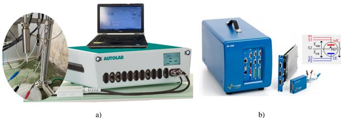
**Figura 3.29.** Potenciostato a) Autolab PGSTAT12 de Metrohm Hispania, y b) biológico SP-300 con tierra flotante; junto con la colocación en el autoclave de cada pinza de cocodrilo.
