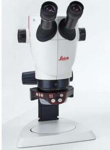
*Figura 3.11. Estereomicroscopio utilizado para la detección de picaduras.*
