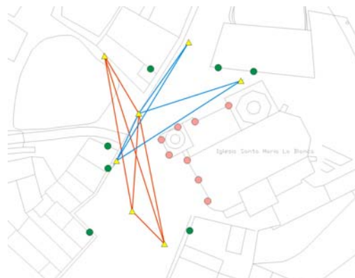
Figura 39. Croquis de la red de vértices de observación (con sus enlaces) y la red de señales de puntería.
