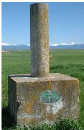
Figura 56. Ejemplo de pilar de observación geodésico
