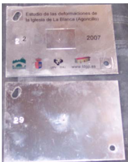
Figura 89. Imagen de las placas de puntería de acero inoxidable, con y sin el acetato adherido.
