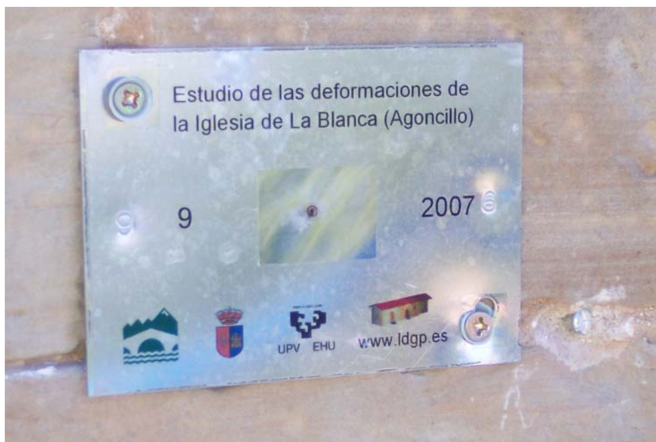
Figura 64. Ejemplo de punto de observación con doble señalización (Diana y Clavo)
