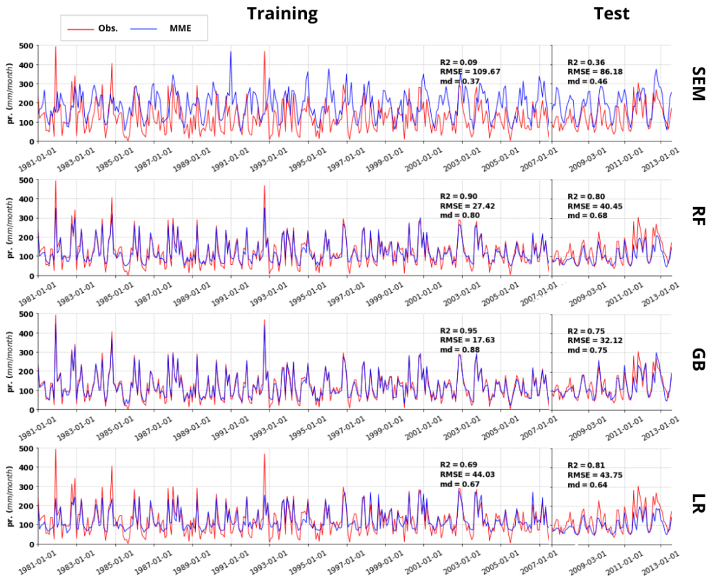
3.4 IRUDIA: Spatially averaged observed precipitation and simulated precipitation time series and evaluation metrics (SEM and ML-MME) for the training (1980–2006) and test (2007–2015) periods. Batez besteko prezipitazio behatua eta prezipitazio simulatuaren denbora-serieak eta ebaluazio-metrikak (SEM eta ML-MME) entrenamendu-aldietarako (1980–2006) eta proba-aldietarako (2007–2015).
