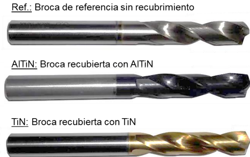
Figura II-34. Brocas ensayadas con sus recubrimientos.
