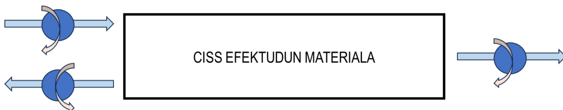
Irudia 5: Korrante elektriko bat CISS efektudun material kiral batetik pasaraztean mota jakin bateko spinak soilik garraiatzen dira.
