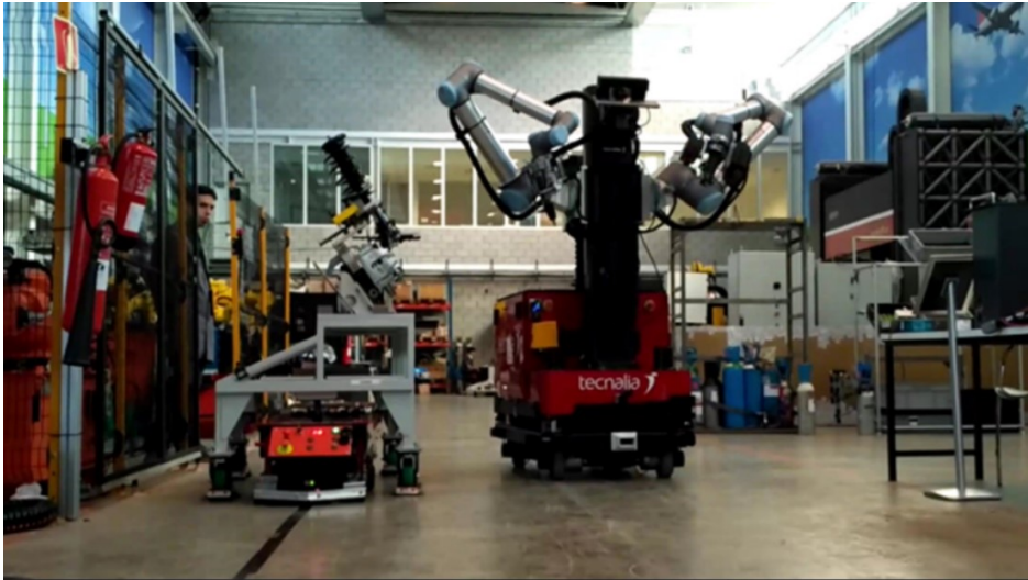
Figura 3.8: AIMM siguiendo al carrito tirado por el AGV para realizar tareas de roscado
