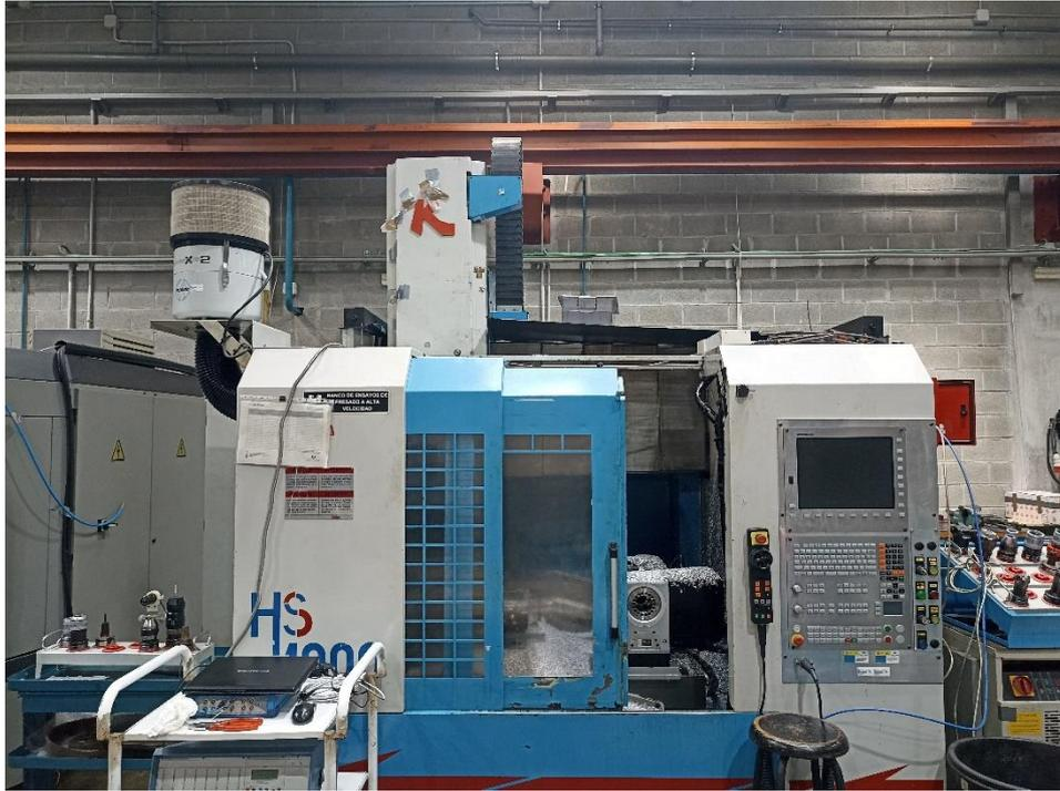
*Ilustración 16. Centro de mecanizado.*
