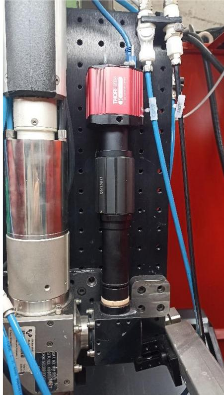
*Ilustración 14. Cámara coaxial.*
