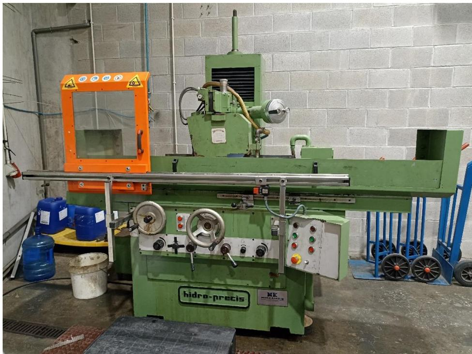
*Ilustración 17. Rectificadora plana.*
