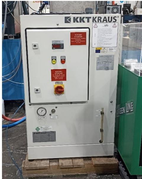
*Ilustración 9. Refrigerador láser.*
