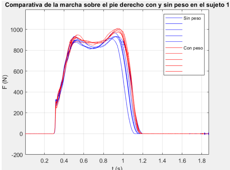
Ilustración 55 Fuerzas verticales en el pie derecho S1: marcha con y sin peso
