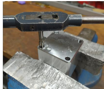
Ilustración 25 Proceso de enroscado del taco
