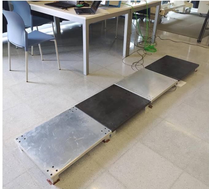
Ilustración 28 Instalación de la pasarela dinamométrica para la evaluación de la marcha
