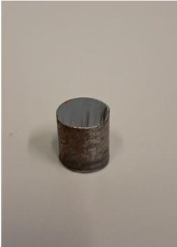
El SS-04 ha sido recepcionado en forma de barras de 10mm de diámetro. Debido al pequeño tamaño de la muestra se ha tenido que empastillar para poder manipularla. En el [Anexo 1](#) se encuentra información detallada sobre el proceso de empastillado.
