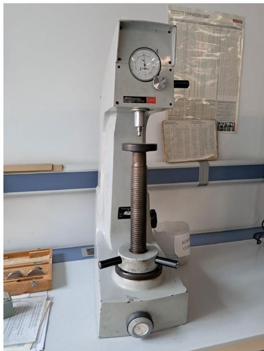
Figura 101. Durómetro Hoytom 1003 A
